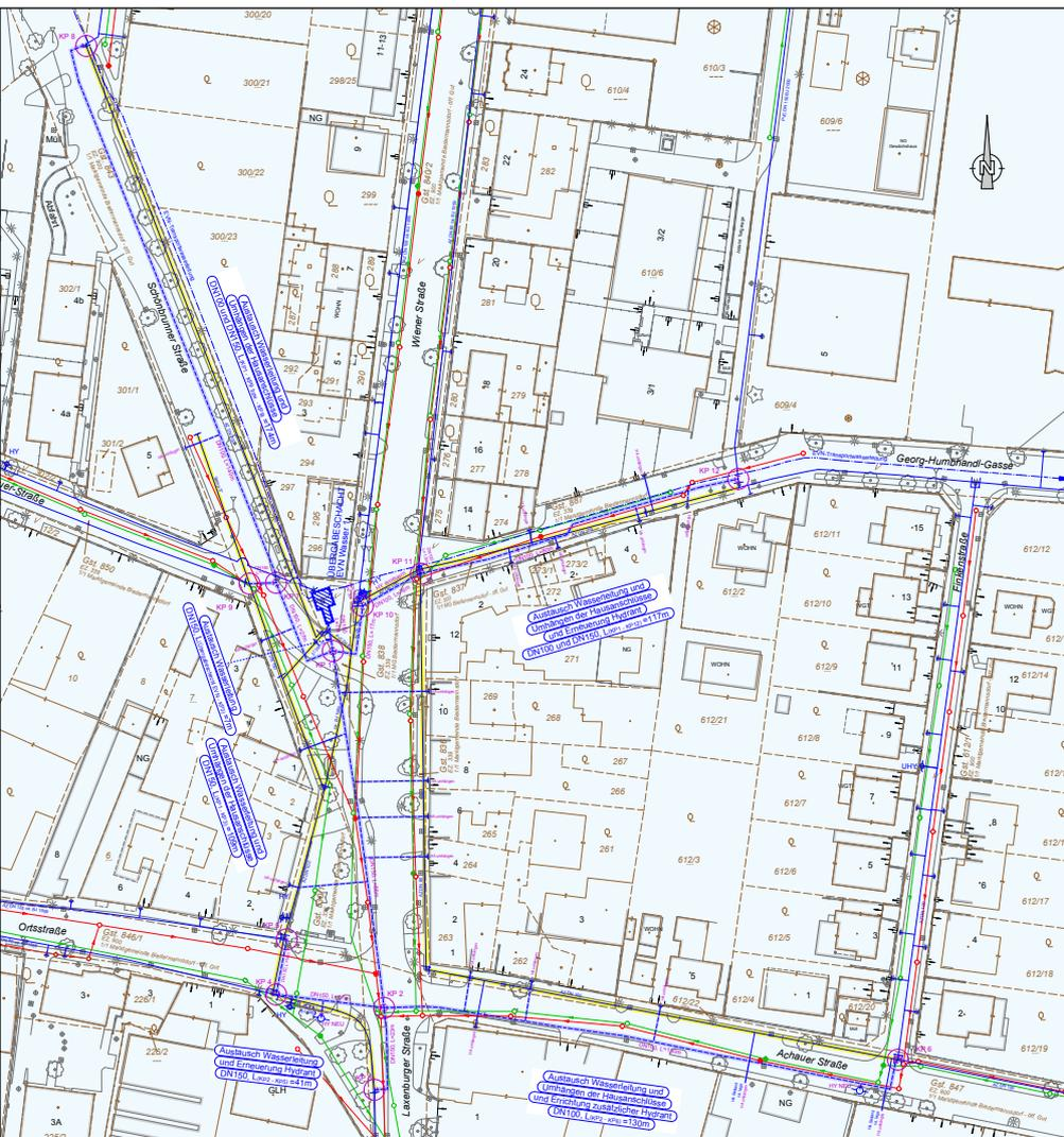
Damit sollen Beeinträchtigungen für Anrainer, Gewerbetreibende und alle Verkehrsteilnehmer auf ein Minimum reduziert werden. Die neue Wasserleitung wird aufgrund bestehender Einbauten, Provisorien und der Verkehrsführung in einer neuen Trasse verlegt. Nach Totlegung der alten Wasserleitung werden die Hausanschlüsse auf die neue umgehängt. Die abschließende Verschleißschicht wird nach Fertigstellung des Gesamtvorhabens gebündelt im Sommer 2022 hergestellt.
