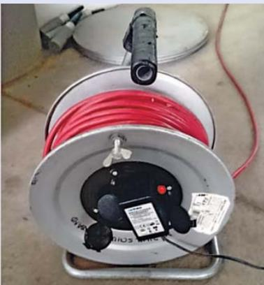
Bei Anschluss von Geräten mit geringer Leistungsaufnahme (Bild) besteht keine Überhitzungsgefahr der Kabelrolle.
